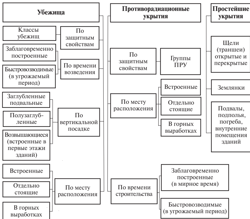
Рис. 1.1. Классификация защитных сооружений гражданской обороны
